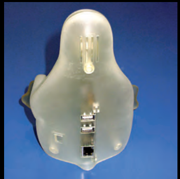
Prototipi dei vari componenti di Tux. Si noti il particolare della verifica prototipale relativa a connessioni USB e di rete
