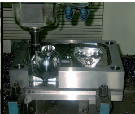
Fresatura della matrice e del punzone dello stampo
