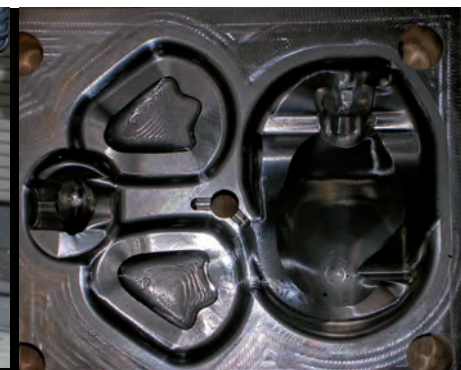
Particolare dello stampo, dal quale risulta il dettaglio della lavorazione superficiale
