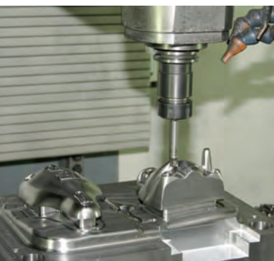
Lavorazione di finitura dello stampo per ottenere superfici appropriate
