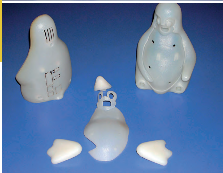
Verifiche di montaggio della scheda nell'alloggiamento interno
