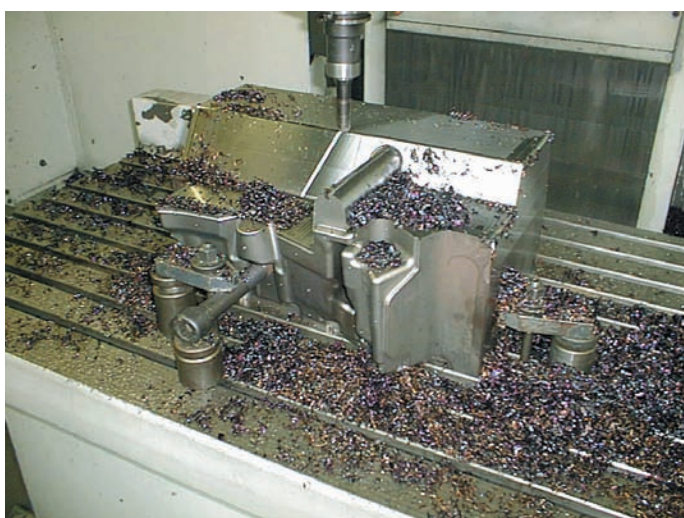
Il centro di lavoro adottato da Cad 2001 Engineering amplia le potenzialità del team, la cui progettazione Cad può estendersi all'area delle lavorazioni Cam, in linea con il principio di un servizio tecnologico completo
